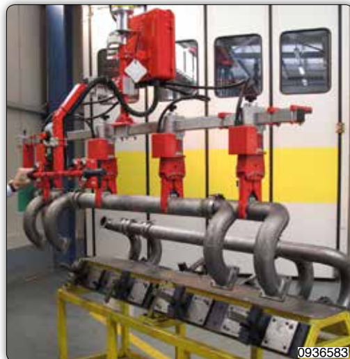
Manipulateur équipé d'un outil composé de quatre têtes de préhension réglables à commande pneumatique pour la prise de collecteurs d'échappement.
