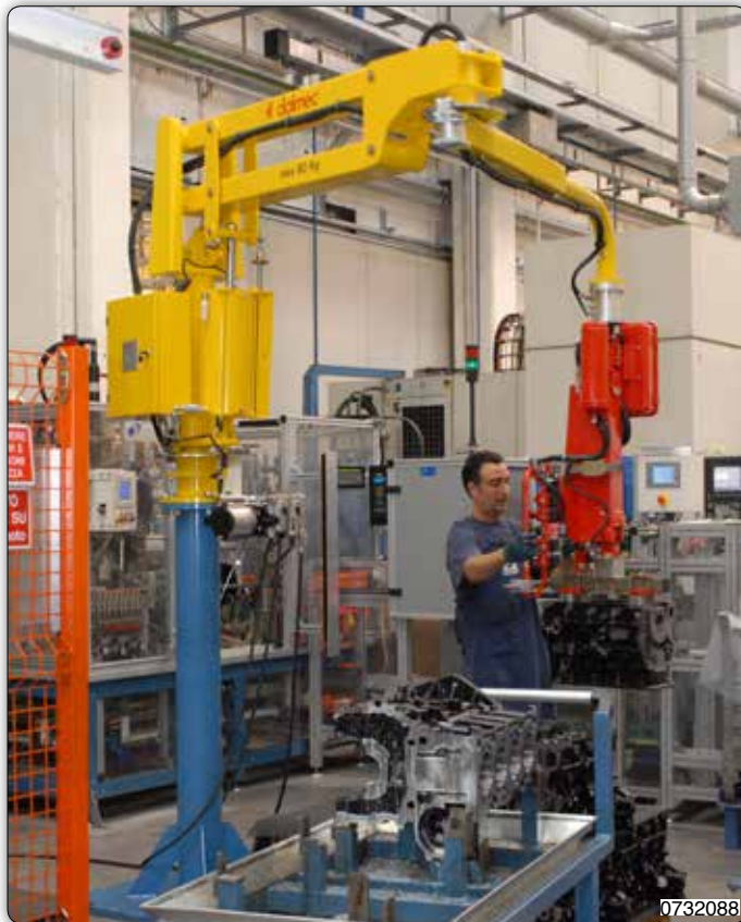
Manipulateur Partner sur colonne pour la manipulation de carters moteur.
