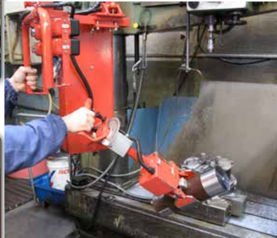
Manipulateur Micropartner équipé d'un outil à pince pneumatique, avec inclinaison pneumatique, adapté à la manipulation de moyeux en asservissement d'une machine outil.
