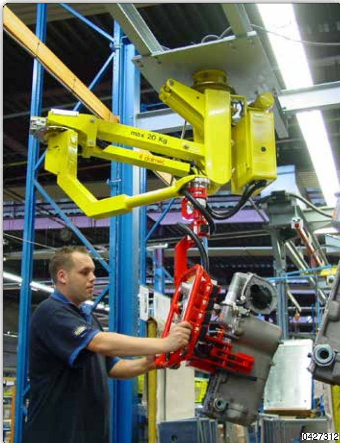
Manipulateur type MIF en exécution aérienne fixe, équipé d'un outil de préhension pour la manutention d'éléments de chaudière.
