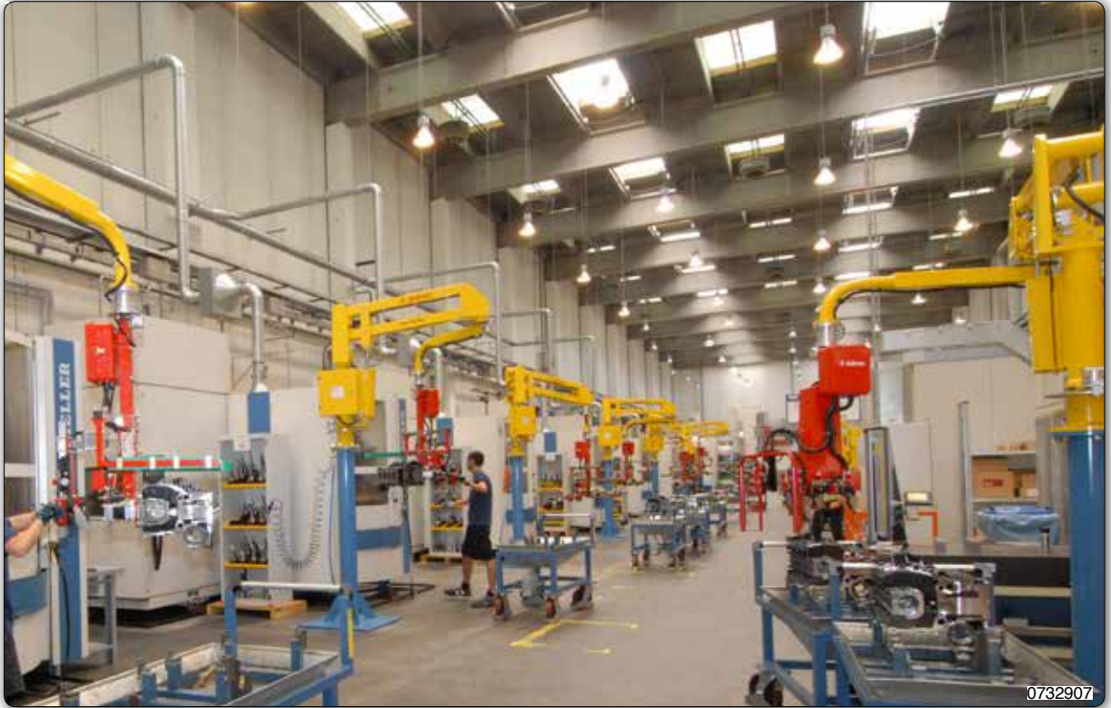
Manipulateurs sur colonne équipés chacun d'un outil à pince pneumatique pour la manipulation de lames de ressort sur une chaîne de peinture.
