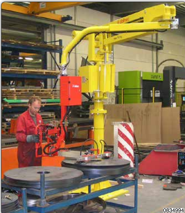
Manipulateur Partner équipé d'un outil de préhension à ventouses à entraxe réglable pour la prise de tôles.
