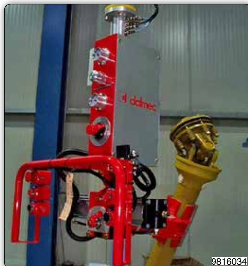
Manipulateur équipé d'un outil à pince pneumatique pour la prise et le retournement de transmissions.
