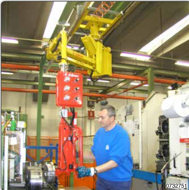
Manipulateur Micropartner équipé d'un outil à pince pneumatique, avec inclinaison pneumatique, adapté à la manipulation de moyeux en asservissement d'une machine outil.
