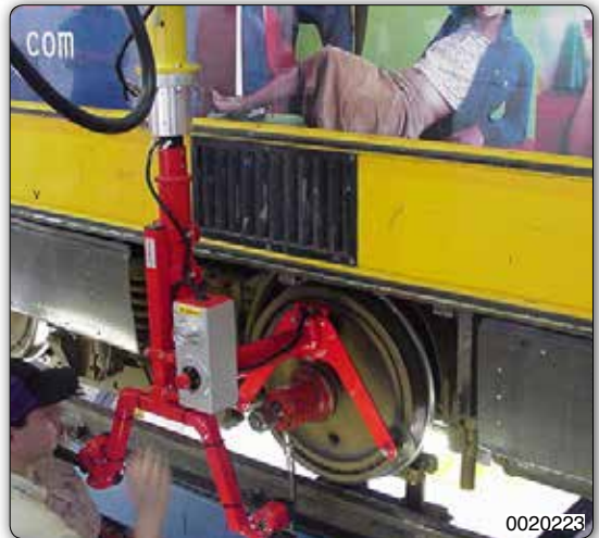
Manipulateur avec outil de préhension à pince pneumatique conçu pour la prise de la roue et sa manutention entre le chariot et la voiture ferroviaire.
