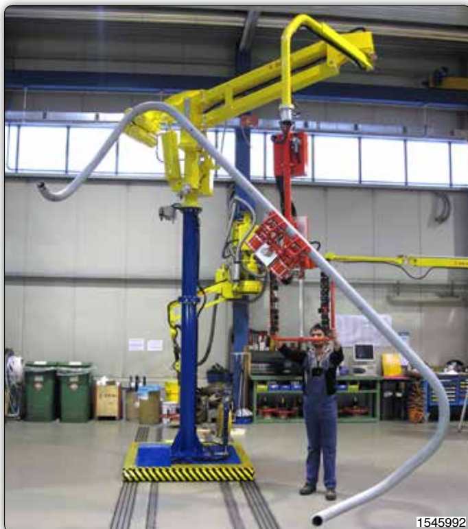
Manipulateur Maxipartner type MXC sur colonne avec outil de préhension à pince pneumatique pour le transfert de pièces mécaniques de palette à machine-outil. La colonne est montée sur base roulante motorisée.
