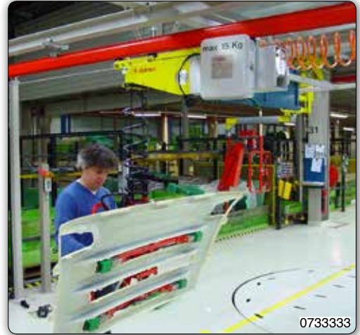
Manipulateur aérien mobile type MPS équipé d'une pince pneumatique pour la prise et la manipulation de pièces de carrosserie.
