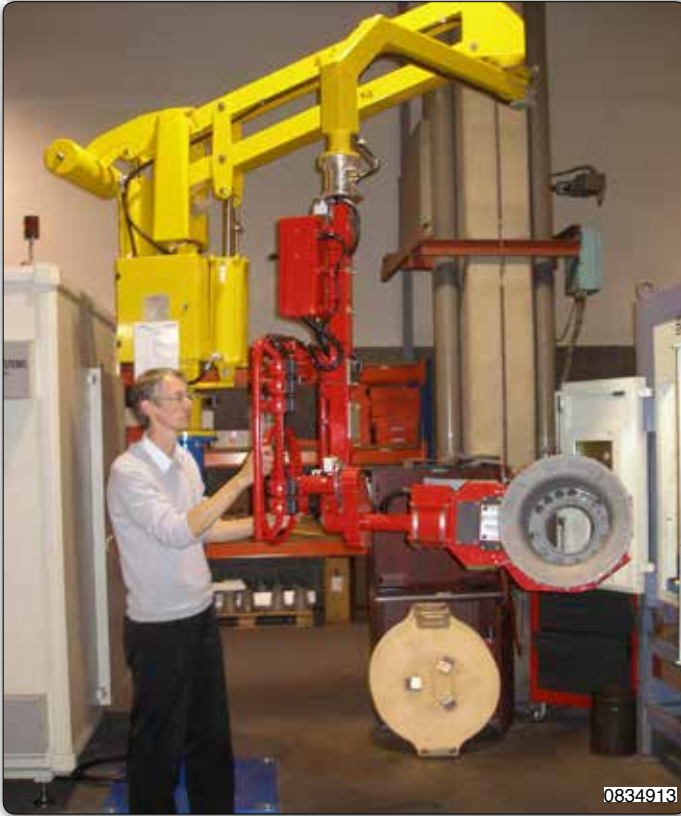
Manipulateur Partner sur colonne équipé d'un outil à serrage pneumatique pour la manipulation de tambours de frein. L'outil permet la rotation manuelle à 180° du tambour.
