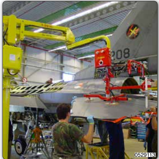
Manipulateur équipé d'un outil à ventouses conçu pour la manipulation d'éléments d'une aile d'avion.
