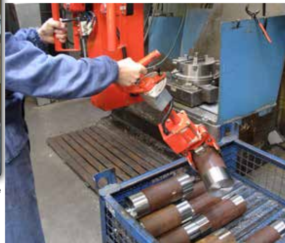
Manipulateur équipé d'un outil à pince pneumatique pour la prise et le basculement pneumatique à 90° de bouteilles.
