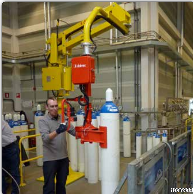
Manipulateur équipé d'un outil à pince pneumatique pour la prise et le basculement pneumatique à 90° de bouteilles.
