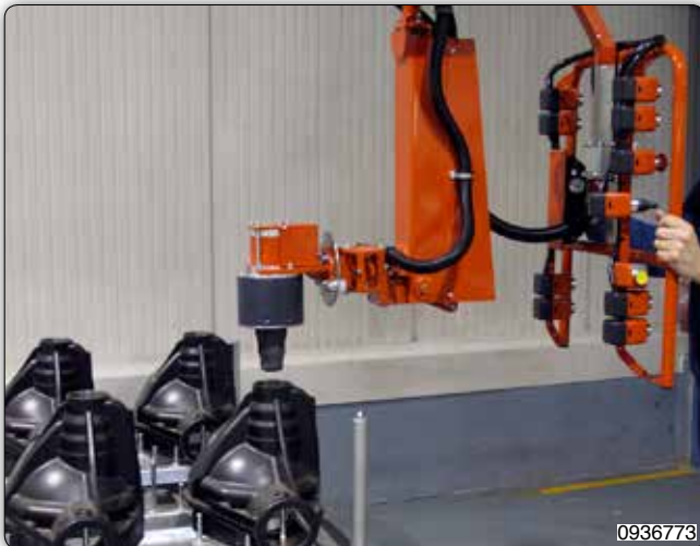
Manipulateur sur colonne type Partner. L'outil de préhension à pince pneumatique permet la manipulation de carters et, après inclinaison et rotation assistées pneumatiquement, leur chargement sur une presse d'estampage.
