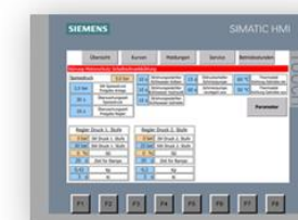
Ecran tactile pour contrôle de l'homogénéisateur
