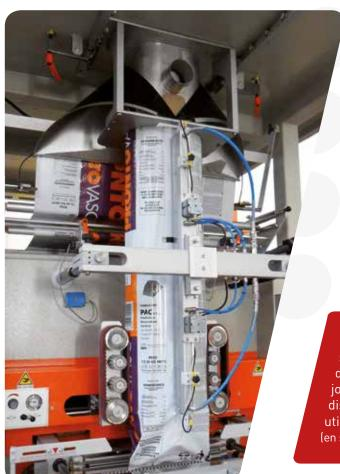
Les ensacheuses verticales automatiques FFS-V du constructeur ESSEGI sont destinées à former, remplir et fermer des sacs à partir d'une bobine de film plastique à plat.
