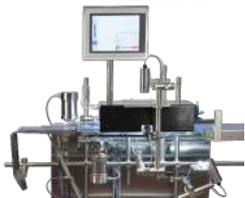
**Vision neuronale**, contrôle sur-mesure en milieu industriel avec un système de traitement d'image pour analyser, inspecter, identifier, positionner, mesurer, trier, et classifier.
