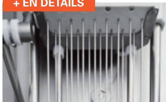
■ Registre des aiguilles IR 17 (commande individuelle)
