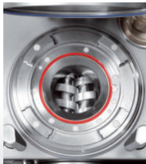
■ Double vis en place (trémie relevée)
