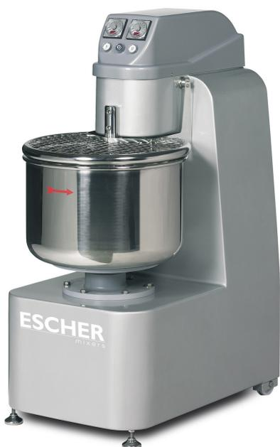
Pétrins à spirale à cuve fixe à un moteur. Deux vitesses, un sens de rotation de la cuve, transmission par courroies, commandes manuelles ou version automatique avec minuterie électronique.
