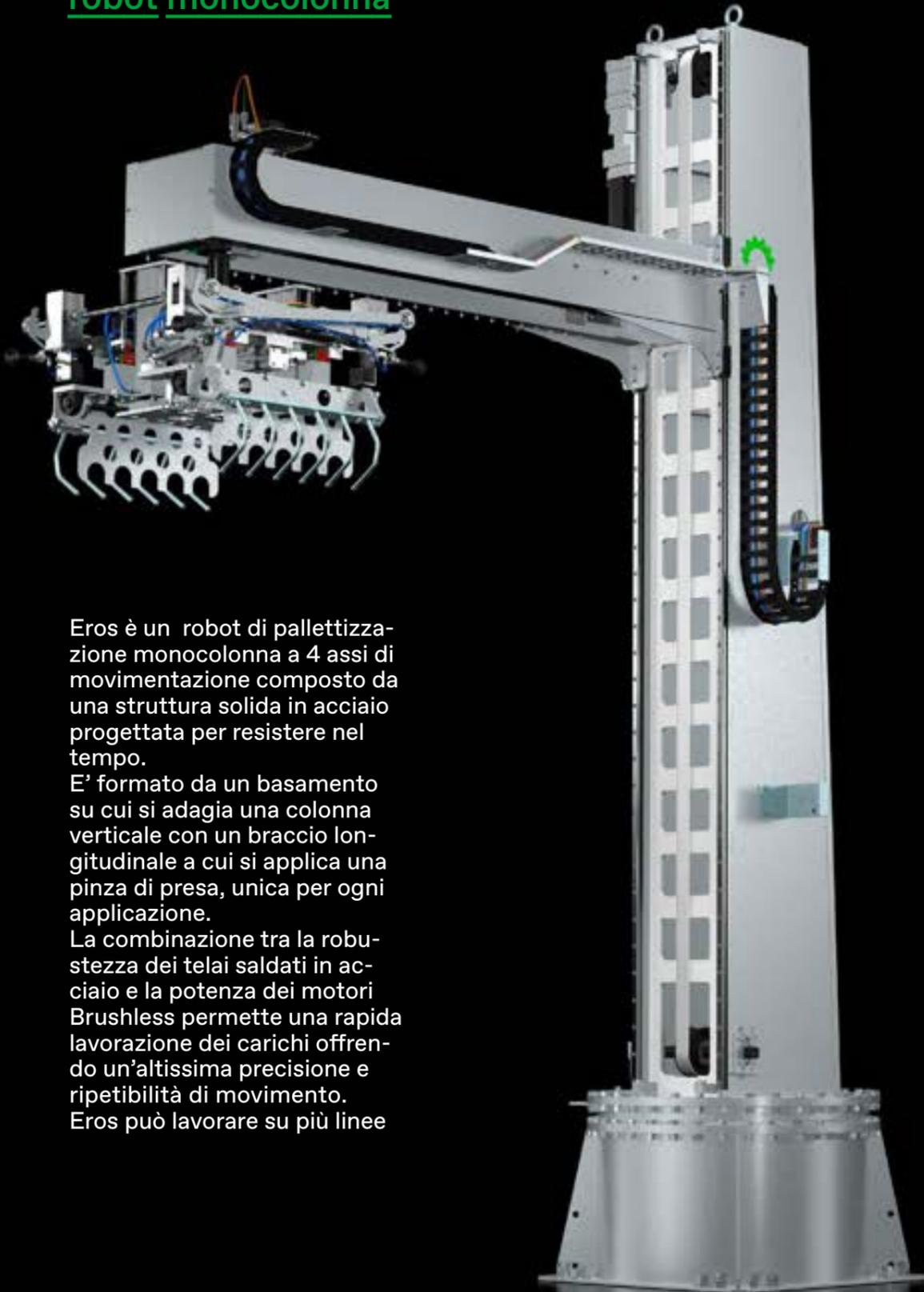
Eros è un robot di pallettizzazione monocolonna a 4 assi di movimentazione composto da una struttura solida in acciaio progettata per resistere nel tempo.
