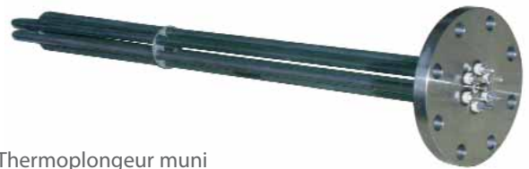
Thermoplongeur muni d'une entretoise, pour maintenir les épingles de grande longueur. Photo : thermoplongeur 30 kW, longueur sous bride LT : 900 mm
