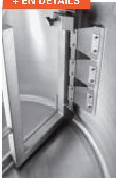
■ Cuve et pâles en inox alimentaire, facilement démontables sans aucun outil
