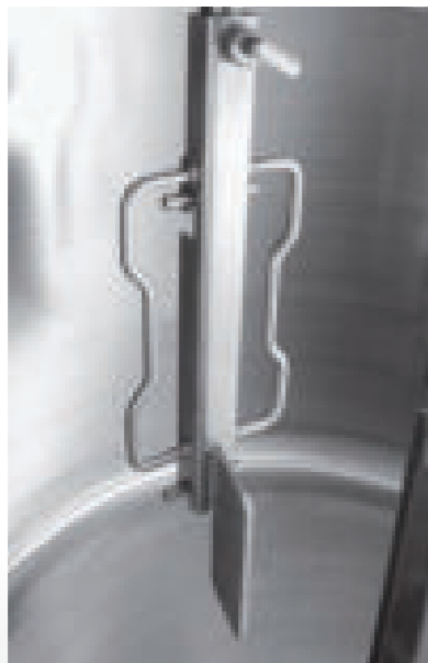
■ Outil de brassage performant pour un mélange homogène de haut en bas
