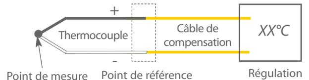
(1) : Température ambiante dans laquelle doit se trouver le câble de compensation, pour éviter des perturbations sur la transmission de la mesure.
